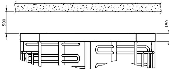
En instalaciones en interiores o bajo techo deberá dejarse una distancia de 500 mm desde la parte superior hasta el techo para poder acceder al mecanismo en las operaciones de instalación y posterior mantenimiento.
