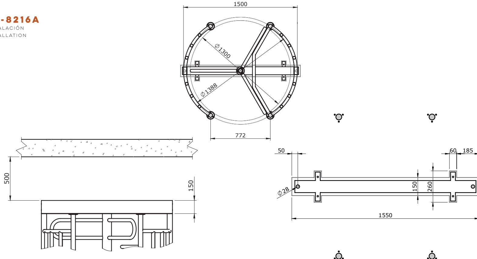
En instalaciones en interiores o bajo techo deberá dejarse una distancia de 500 mm desde la parte superior hasta el techo para poder acceder al mecanismo en las operaciones de instalación y posterior mantenimiento.
